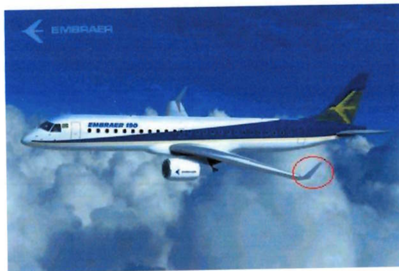
Figura 1.1: Aeronave Embraer 190 com winglets .
